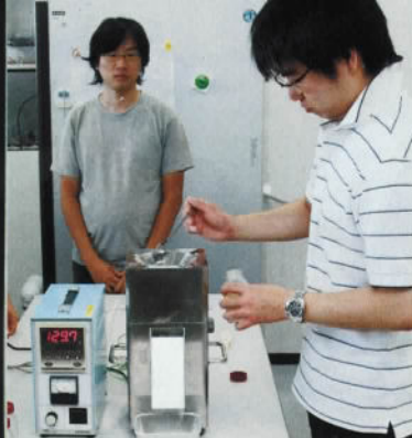
★熱を加えながら挽けるよう設計した実験用の製粉機で、生米をそのまま入れて米粉を作る
